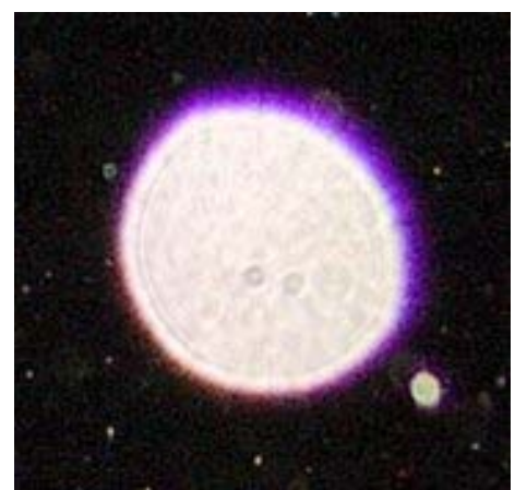
Fig.6.3.7: L'aberrazione cromatica si manifesta come un bordo colorato sulle immagini brillanti
